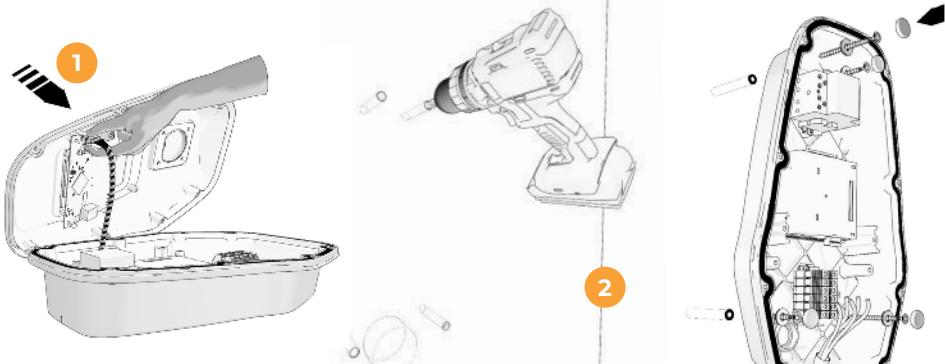
3. Führen Sie die ausreichend dimensionierte Zuleitung (min. 2,5mm<sup>2</sup>) sowie die RS485 Steuerleitung (z.B. CAT6) von hinten oder unten in die Ladestation ein und schließen Sie die Adern an die entsprechenden Klemmen an.
